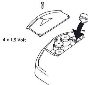
Entfernen Sie die Schraube des Batteriegehäuses mit einem geeigneten, kleinen Schraubenzieher. Zum Öffnen des Batteriegehäuses schieben Sie den Deckel zur Seite weg. Entnehmen Sie die alten Batterien. Setzen Sie 4 neue Knopfzellen ein. Um die volle Funktionsfähigkeit des Spielgeräts zu gewährleisten, verwenden Sie bitte ausschließlich Batterien des folgenden Typs: 1,5 Volt, LR 44. Achten Sie darauf, daß das Pluszeichen (+) oben ist, wie auf der Skizze gezeigt. Mischen Sie keine
